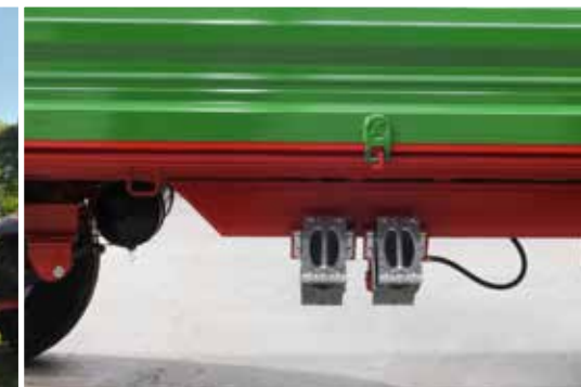
Radkeile mit sicheren Haltevorrichtungen als serienmäßige Ausrüstung
