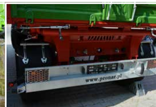
Homologierte Stoßstange mit integrierten LED-Rückleuchten und abnehmbarem Schutzgitter
