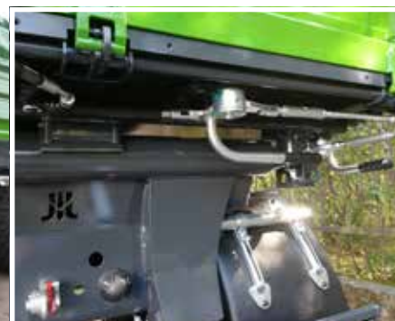
Nutzerfreundliche, hydraulische Bordwandverriegelung (Option)
