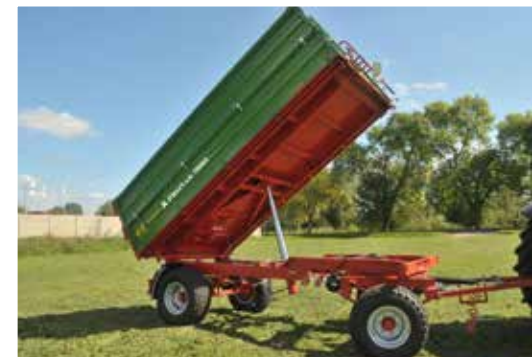
Ladekiste mit dreiseitigem Öffnungssystem und konischem Boden (Anhängerbite erweitert sich heckseitig um 50 mm)
