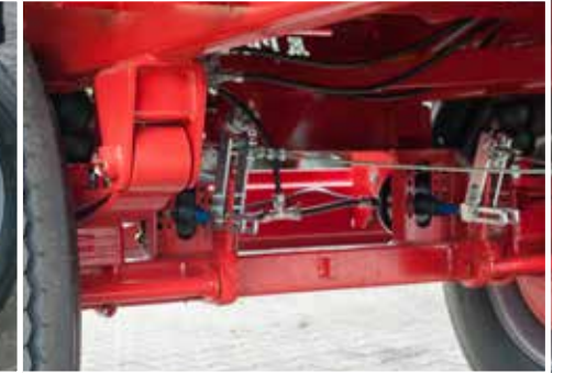
Solide Parabelfederung erhöht den Fahrkomfort
