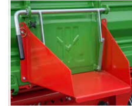
Optionale Auslaufgasse ermöglicht gezielte Entladung
