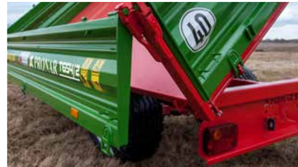
Kippwinkel: nach hinten 50°, nach links und rechts 46°
