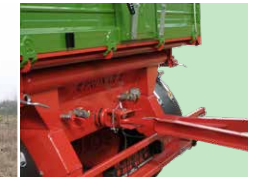
Hintere Anschlüsse zur Anhängung eines zweiten Anhängers
