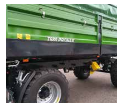
Seitliche, klappbare Blechrutsche (links o. rechts), erleichtert das Entladen
