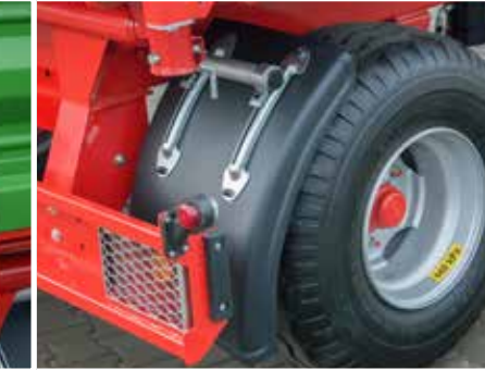
Kotflügel auf der Hinterachse und Rücklichter mit Schutzgitter
