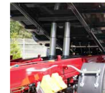
Zwei Teleskopzylinder zur optimierten Entladungssicherheit
