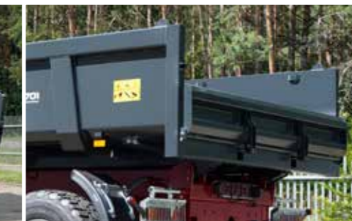
Hydraulische Heckklappe 370 mm hoch
