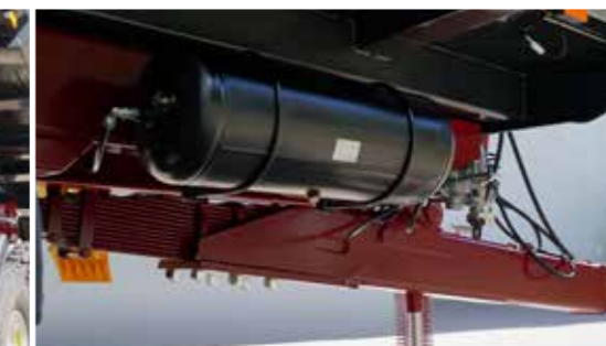
Gefederte Deichsel erhöht den Fahrkomfort
