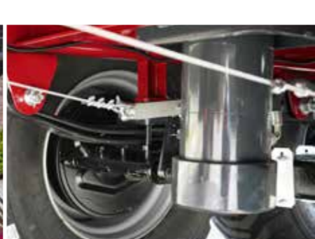
Tandemaufhängung mit Längslenkern; mit Halbachsen mit Trommelbremsen ausgestattet
