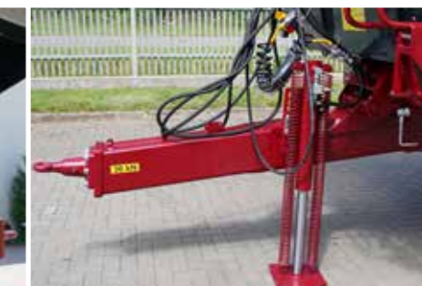
Zuverlässiger Stützfuß dank Hydrauliksystem
