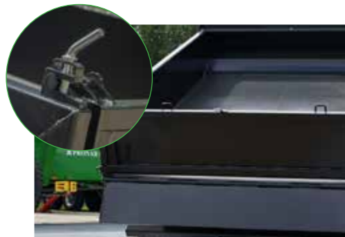
Pendelnde Heckklappe zur bequemeren Entladung
