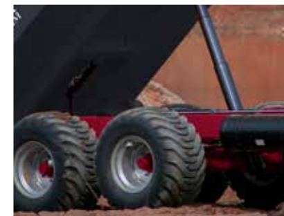
Tandem – Fahrwerk mit Trommelbremsen 300x90mm
