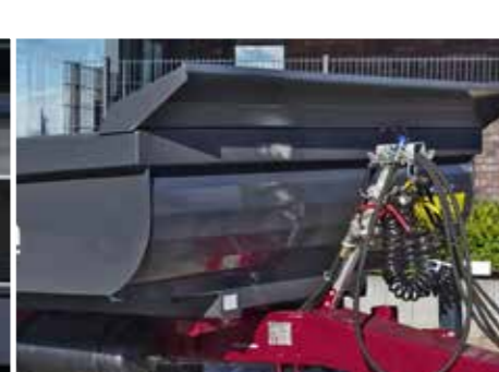
Abgerundete Vorderwand der Ladekiste zur erleichterten Entladung mittels Grabenlöffel
