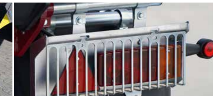
Mit Schutzgittern versehene Rücklichter zur Sicherheitsgewährleistung
